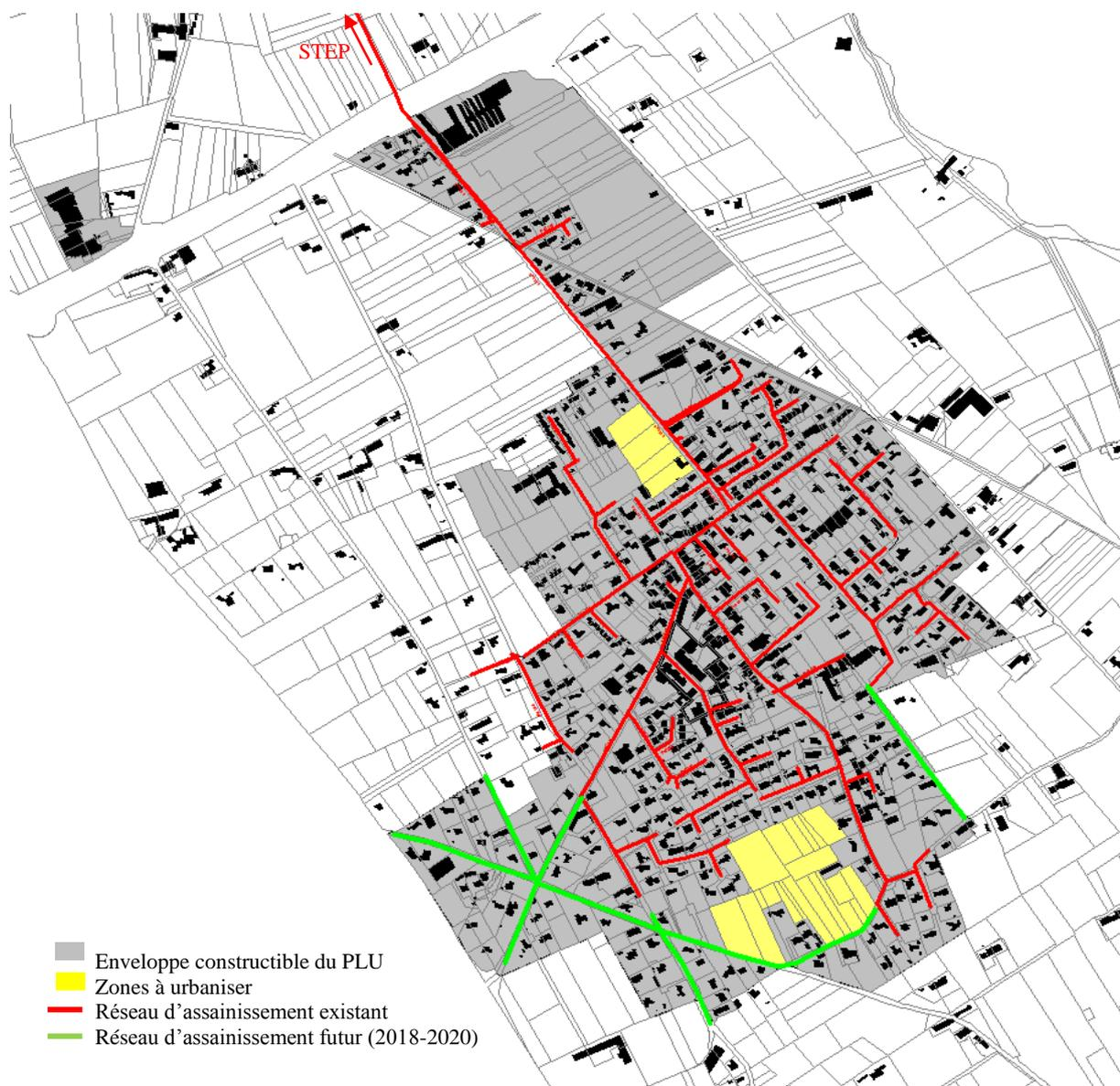
*La station d'épuration possède aujourd'hui une capacité de 2100 Équivalents Habitants (EH). Si la charge hydraulique moyenne a été jugée comme trop importante par rapport à la capacité nominale de la STEP, les travaux déjà engagés et prévus dans la mise à jour du schéma directeur permettront d'améliorer le rendement de la station ainsi que les rejets et donc de diminuer les incidences potentielles sur l'environnement.*
